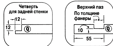
Рис. 7. Соединение деталей книжного шкафа
