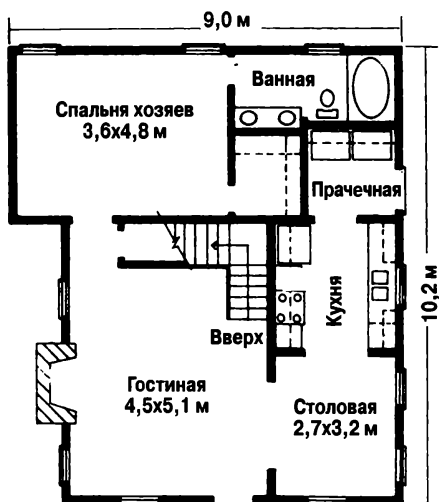
Первый этаж (высота потолка 2,7 м)
