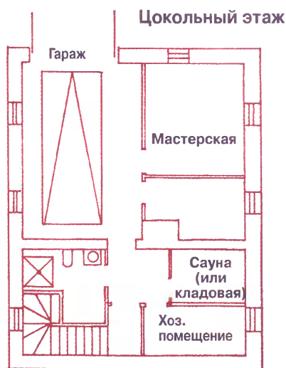
Рис.3. 4-комнатный дом со встроенным гаражом (для участков с уклоном). Планы 1, 2 и цокольного этажей и фасад со стороны въезда в гараж
